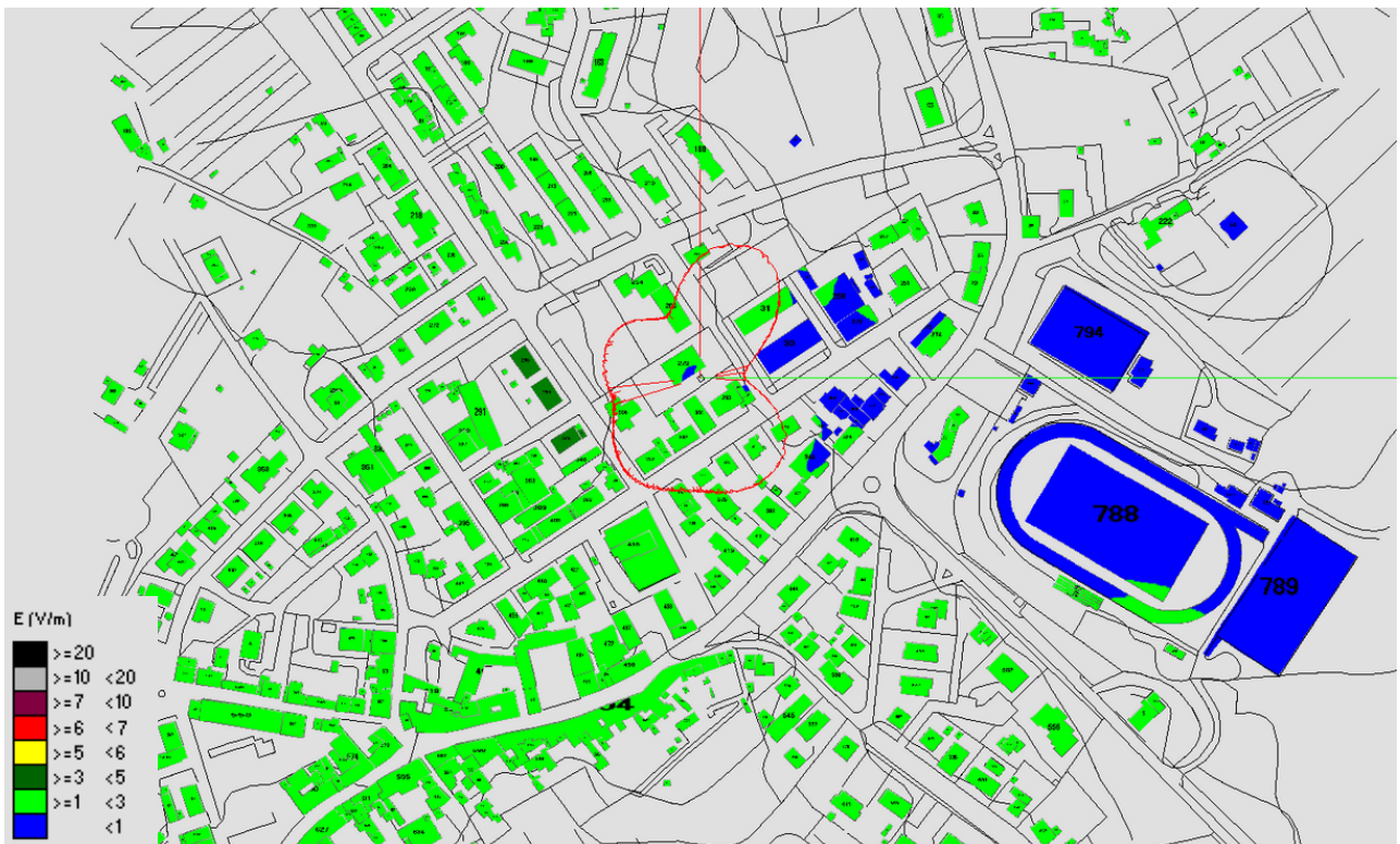
Fig. 13 Impatto elettromagnetico – Zona Via Aldo Moro Centrale Telecom – Vista dall'alto
