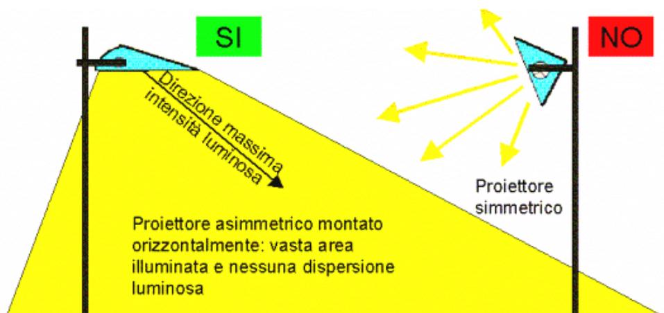
Figura (sopra) Schema di funzionamento dei proiettori. La posizione di montaggio ottimale è 0° rispetto al piano orizzontale, in tal modo non si ha dispersione di luce verso l'alto e si sfrutta la massima funzionalità del corpo illuminante.
